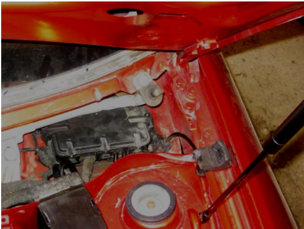
Luukusta saa johdot kuskin jalkatilaan ja vapaa kumimuhvikin siinä on.
