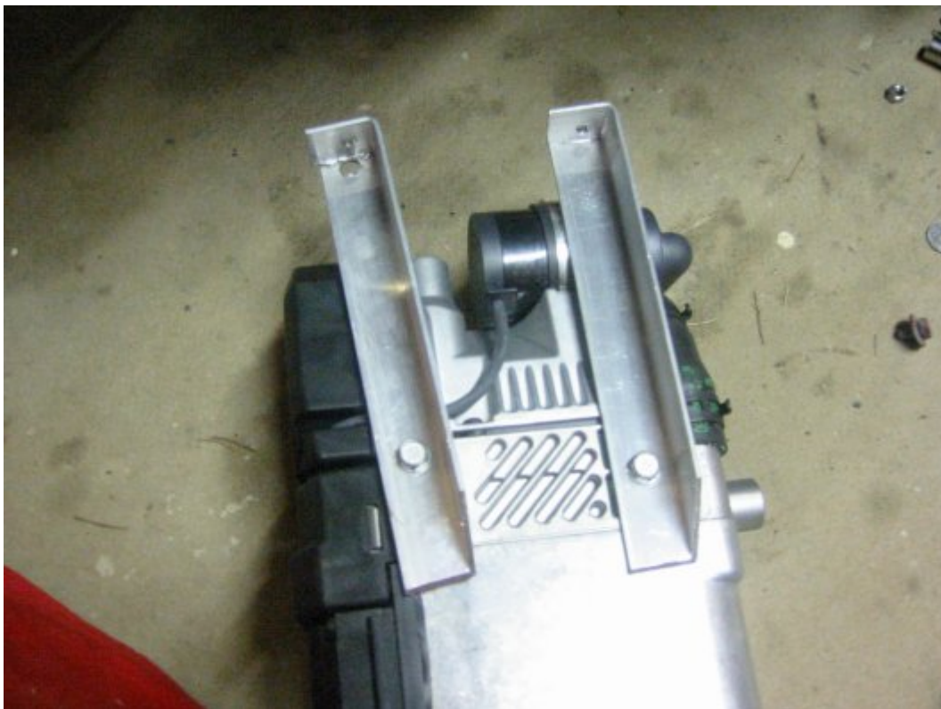
Alumiinikulmasta syntyi mukavasti kiinnikkeet, eipähän ruostu.
