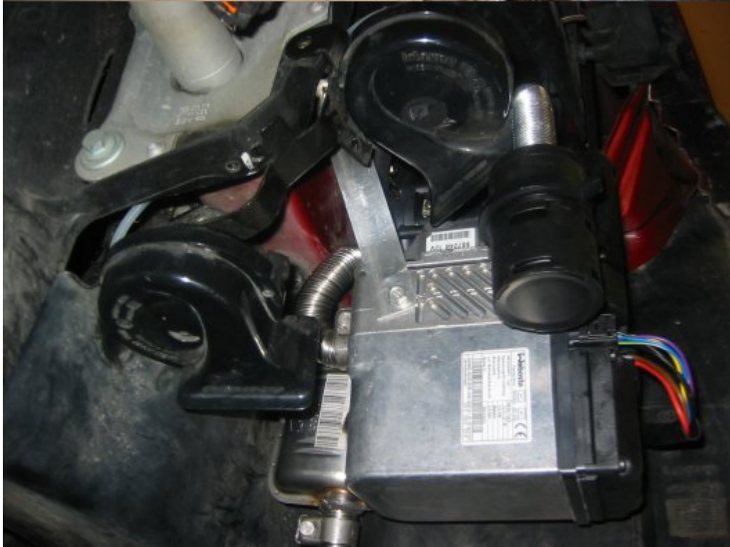
Äänenvaimennin tuolla takana ja pakoputki suunnattuna auton alustaan.
