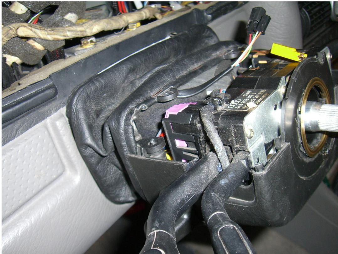
Tässä kuvassa näkyy hyvin nuo nahkapalkeen kiinnityskorvakkeet, joista alemmat tulevat siis suojakansien väliin samoilla ruuveilla kiinni.
