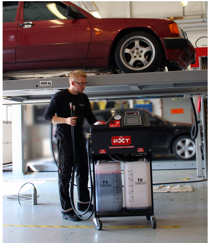
"Kun automaattivaihteisto on kunnossa, pysyy auton kulutuksen normaalina", sanoo Öljypisteestä Lasse Avovaara ja aloittaa öljynvaihtohuollon.
