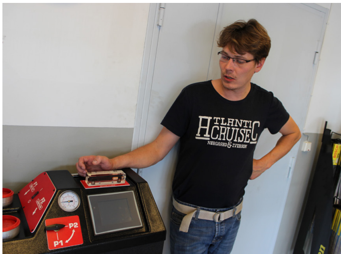
"Vaihteistoöljyn kunnon voi tarkistaa laitteen päällä olevasta putkesta", näyttää Öljypisteestä Timo Nuutinen.
