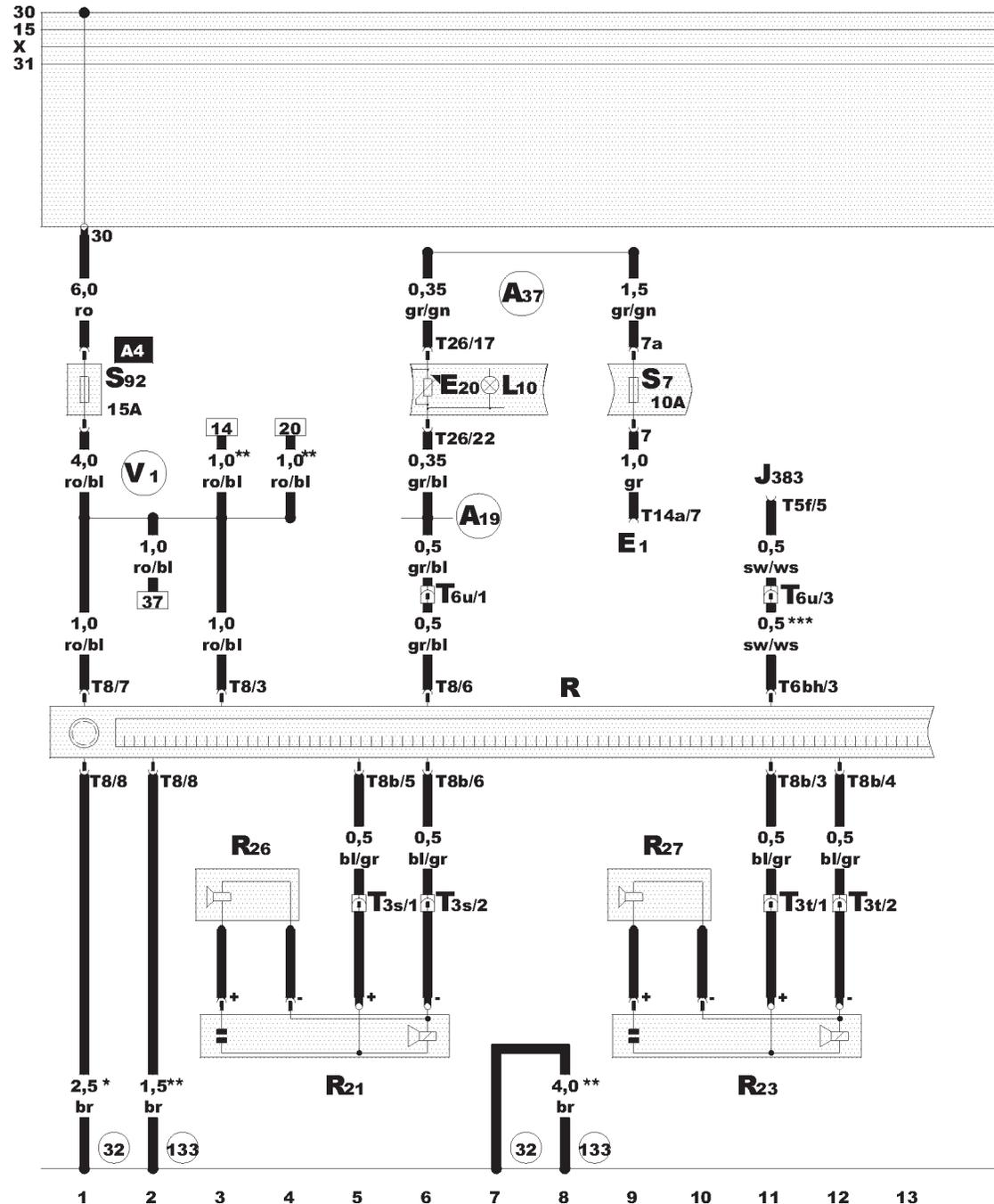
Radio beta-, gamma-, delta- Anlage mit und ohne CD-Wechsler
