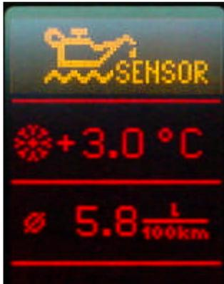
Umbau möglich, das Problem an der Sache ist der kombinierte Ölstands-/ Öltemperaturgeber, der in der Ölwanne sitzt und bei den Modellen ab Juli 99 eingebaut wurde. Mit ihm wurde der Long-Life-Service eingeführt, der Geber misst u.a. die Ölqualität.
